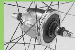
заднее колесо с 8-скоростной втулкой с внутренним механизмом переключения
