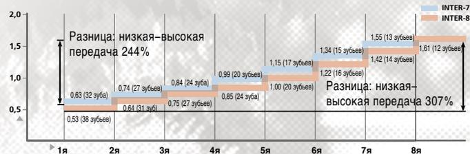
Таблица слева показывает относительные передаточные отношения для втулок INTER-7 и INTER-8 при использовании со звездой в 20 зубьев. Числа в скобках показывают размер звезды, которой соответствует каждое передаточное отношение при переходе к системе с переключателем.
