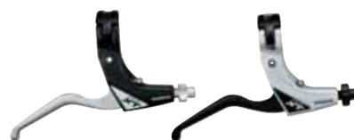
**BL-T780** Тормозные ручки для V-BRAKE
