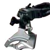
**FD-M817** Передний переключатель DOWN SWING для каретки 83 мм (9 скоростей, две передние звезды)
