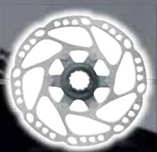
Гидравлический дисковый тормоз (Крепление Center Lock)
