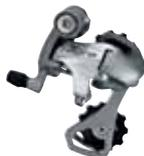
**RD-4600-SS** Задний переключатель (для системы с двумя звездами)
