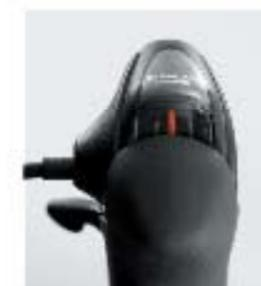
Встроенный оптический индикатор передач (ST-3400)
