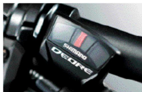
Цифровой оптический индикатор передач
