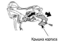
При наложении обмотки руля не закрывайте крышку узла и отверстия для троса. В противном случае замена троса будет невозможна.
