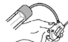
3. Когда в выходящем масле больше не будет пузырьков воздуха, временно перекройте сливной штуцер. Если на тормозную ручку в это время было установлено приспособление для прокачки Shimano, снимите его.
