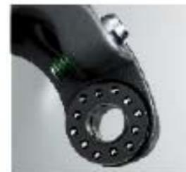
Вкладыш с покрытием и упорный подшипник шарниров снижают трение в тормозе. (DURA-ACE)
