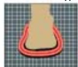
термочувствительный и пластичный материал нагнетается в верхнюю панель
