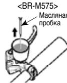
7. При нажатой тормозной ручке быстро (с интервалом примерно 0,5 с) открывайте и закрывайте сливной штуцер для выпуска пузырьков воздуха, которые еще могут оставаться в калиперах. Повторите эту процедуру 2-3 раза. После этого снова заверните штуцер.
