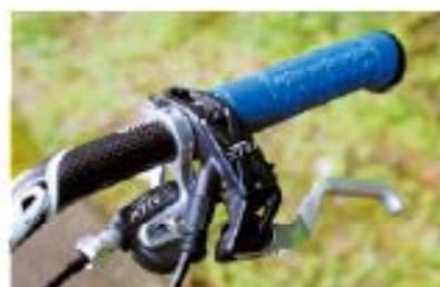
RAPIDFIRE с системой переключения «Top Normal», которая позволяет быстрое переключение даже в чрезвычайных ситуациях, рекомендуется для катания в стиле фрирайда и All Mountain.
