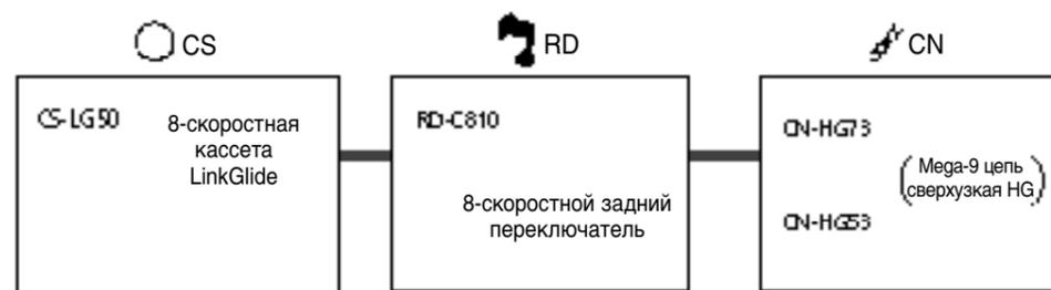
Полная функциональность LinkGlide не может быть реализована в комбинациях, отличающихся от этих. Кроме того, функциональность HG будет снижена, если переключатель RD-C810 используется со звездами HG, но не LinkGlide. Качество переключения LinkGlide достигается при комбинации с шифтерами ST-C503-A(R).
